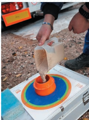
8) Kontrola vhodné konzistence pomocí Hägermannova trychtýře
